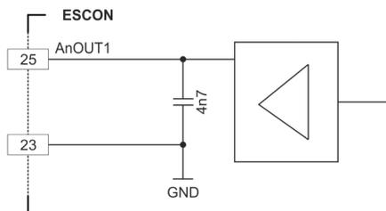
图 3-11 AnOUT1 的连接 (AnOUT2 的连接方式类似)
