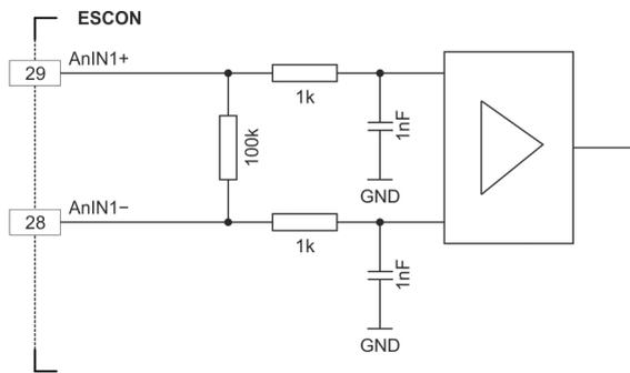
图 3-10 AnIN1 的连接 (AnIN2 的连接方式类似)
