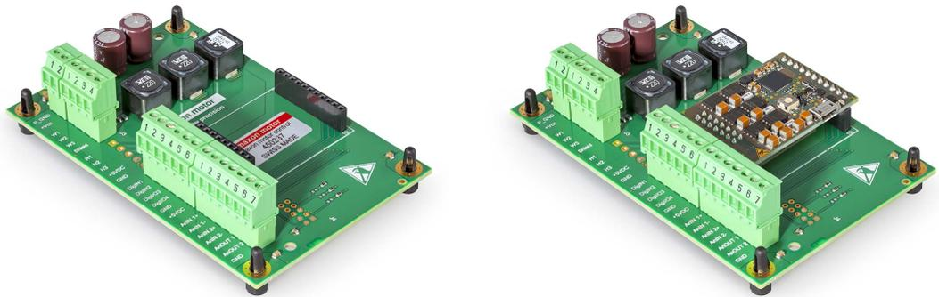
图 5-20 ESCON Module MoBo (左)，其上 ESCON Module 50/4 EC-S (右)
