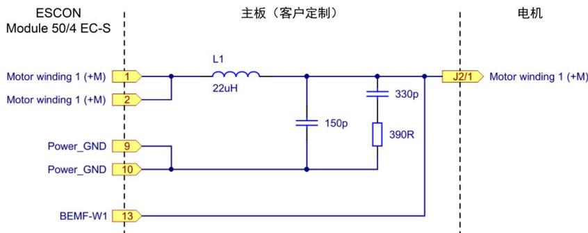
图 5-18 连接电机绕组 1 (对于电机绕组 2 & 3 也类似)
