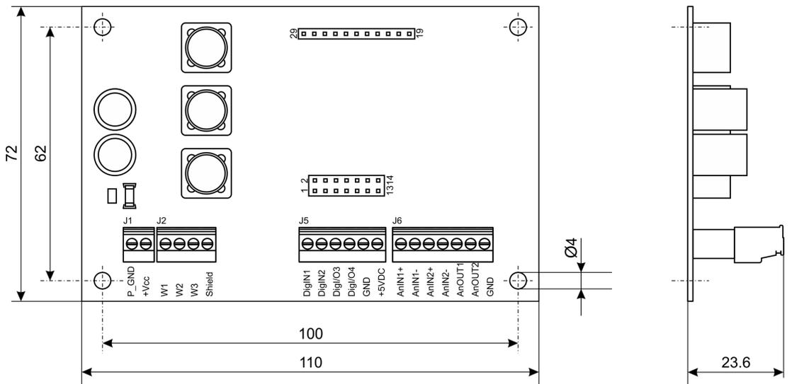
图 5-21 ESCON Module MoBo – 尺寸图 [mm]
