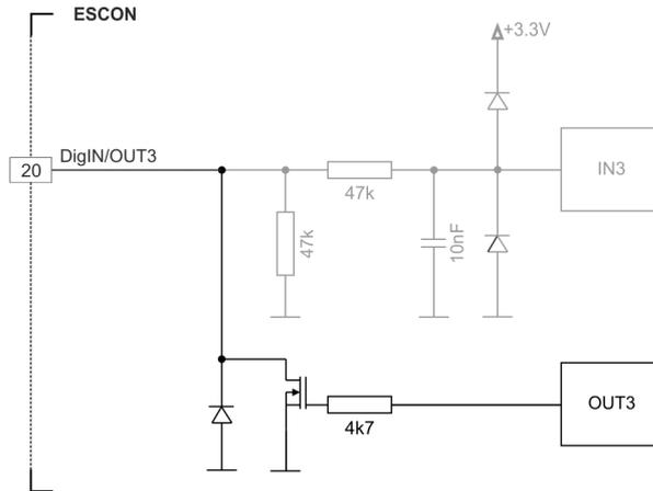
图 3-8 DigOUT3 的连接 (DigOUT4 的连接方式类似)
