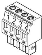
图 5-24 ESCON Module MoBo – 电机连接器 J2
