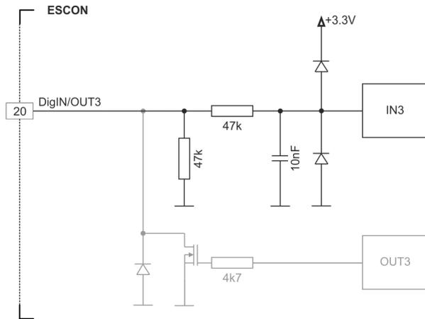
图 3-7 DigIN3 的连接 (DigIN4 的连接方式类似)
