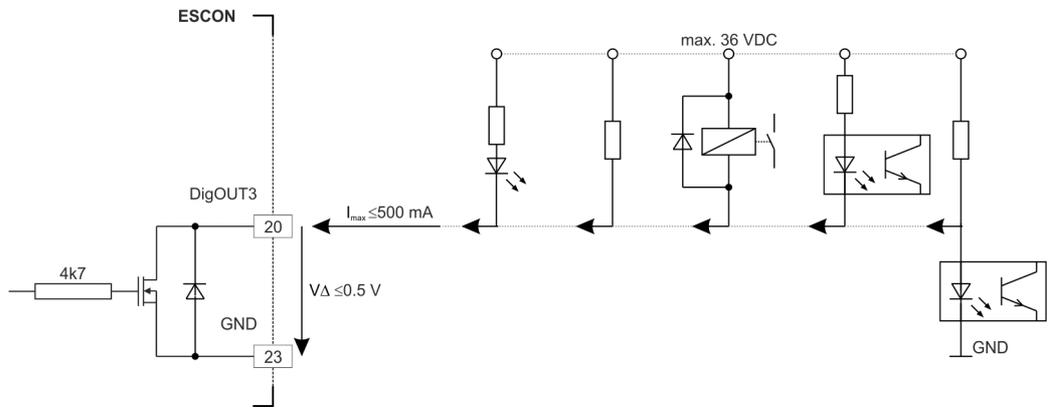
图 3-9 DigOUT3 接线示例 (DigOUT4 的连接方式类似)
