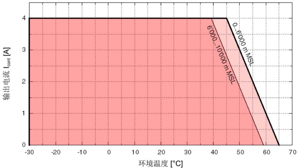
图 2-1 输出电流降低额定功率
