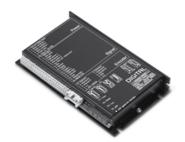
**DES 50/5** 4-Q-EC Servoverstärker Digitaler Servoverstärker mit sinusförmiger Stromkommutierung für die perfekte Regelung von EC-Motoren mit Hall-Sensoren und Encoder und einer Leistung bis 250 Watt.
